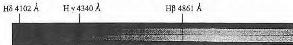
Abb. 3 Spektrum des Sterns Atair aufgenommen am 23.09.2005 mit Meniscas 180/1800 und Objektivprisma 45° BK 2, Belichtung 231 s bei ISO 400
