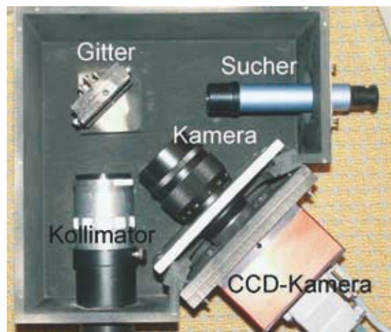
Abb. 2: Fertig gebauter Spektrograf mit Kollimator, Gitter, Kameraobjektiv, CCD-Kamera und Sucher.
