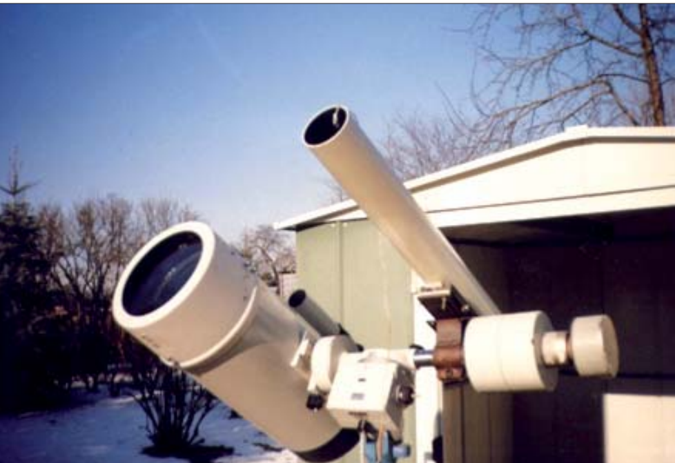
Abb. 1: Objektivprismenspektrograf zur Aufnahme der Nebelspektren.
