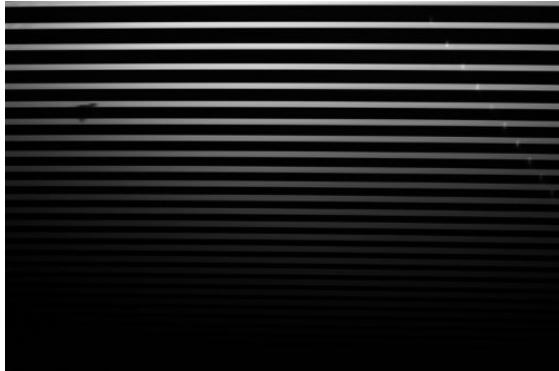
Abb. 14: Echelle-Flat ohne Filter, Belichtungszeit 30 s.
