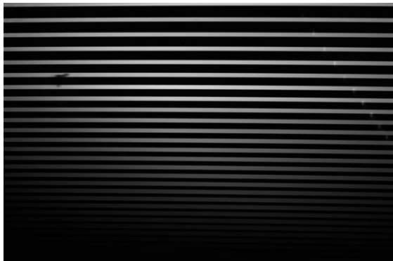
Abb. 15: Echelle-Flat mit Filter, Belichtungszeit 120 s.
