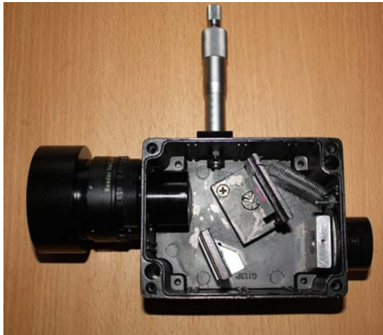
Abb. A1: Bild des geöffneten MiniSPEC. Rechts erfolgt die Ankopplung an das Teleskop.
