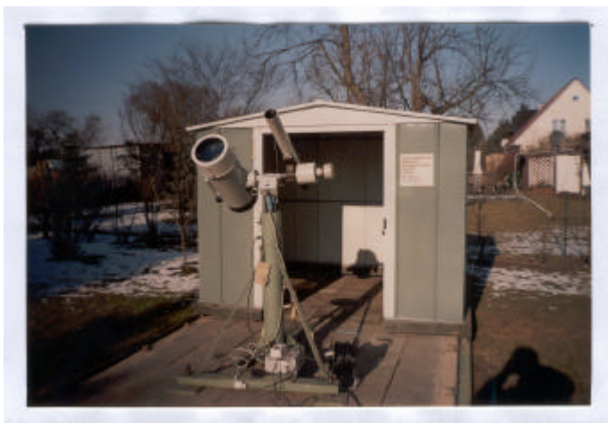
Abb.2: Amateurstation und Zeiss-Meniscas- Spiegelteleskop 180/1800. Wichtige Kenngrößen des Fernrohres sind in Tabelle 1 erläutert
