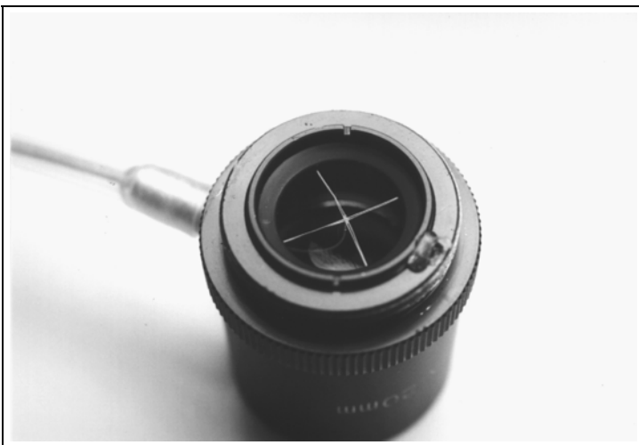
Abbildung 6: Das „Lichtleiterokular“ (ohne 1 \frac{1}{4} Zoll-Hülse) Die Halterung des Lichtleiters im Doppelfadenkreuz
