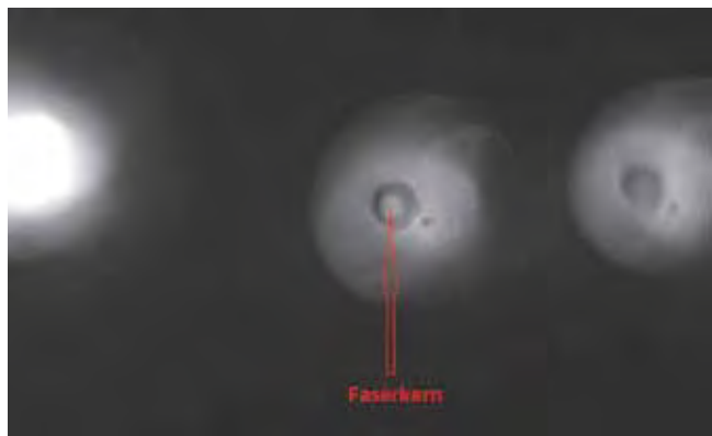
13 Bild von der Guidingkamera, der dunkle Ring um den Faserkern ist die Edelstahlferrule, in der die Faser gefasst ist. Durch die Hinterleuchtung der Faser vom Spektrografen aus wird der Faserkern deutlich abgebildet.
