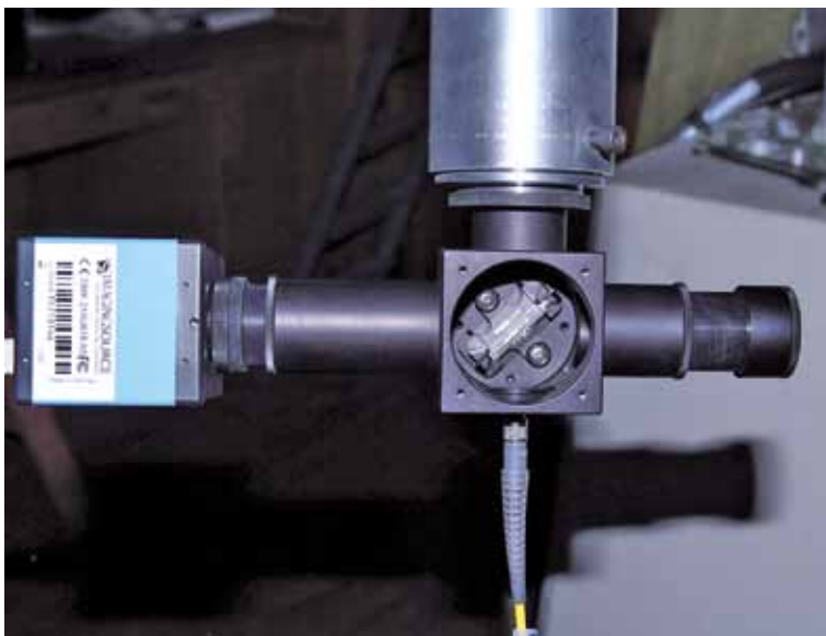
5 Die EasyFiber am Teleskop mit geöffnetem Deckel. In der Mitte ist der Strahlteiler zu sehen.
