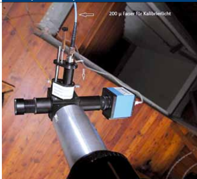
12 EasyFiber-Einheit am Teleskop, in der Mitte die Kalibrierlichteinspeisung mit blauer Faser
