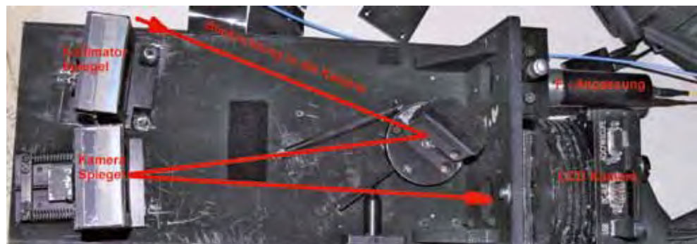
7 Optik zur Anpassung des Öffnungsverhältnisses des Teleskops [5]
